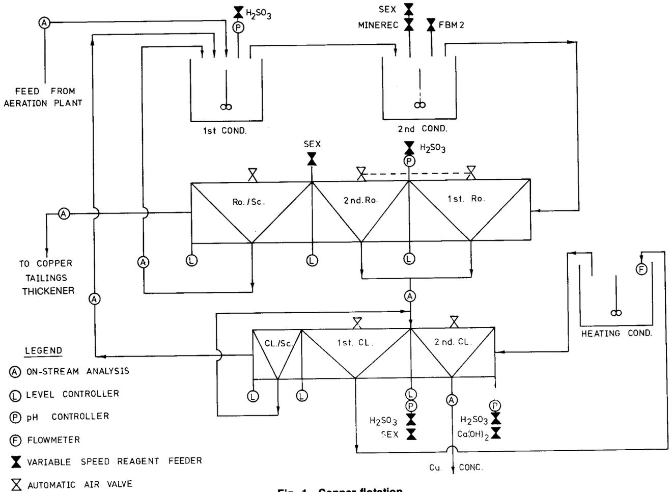
Fig. 1—Copper flotation
