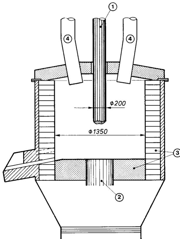
Fig. 1—200 kW pilot furnace
