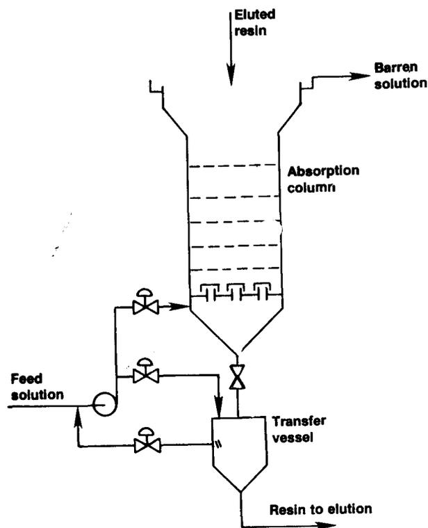
Fig. 1—The NIMCIX contactor
